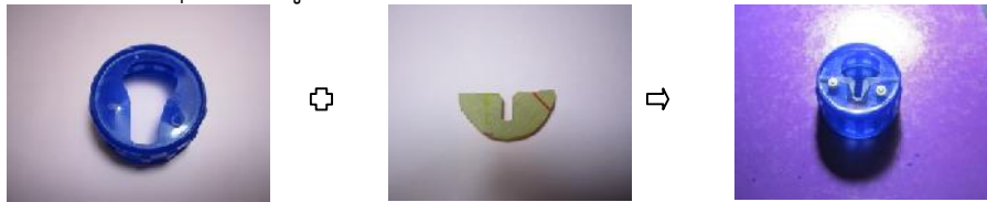
รูปที่ 7. ตัดฝาเกลลอนให้กว้างขึ้นและนำแผ่นพลาสติกที่แบ่งครึ่งไว้มายึดติดกับฝาเกลลอน
